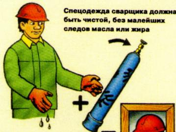
ПОПАДАНИЕ МАСЛА НА ШТУЦЕР БАЛЛОНА С КИСЛОРОДОМ МОЖЕТ ВЫЗВАТЬ ВОЗГОРАНИЕ ИЛИ ВЗРЫВ!
