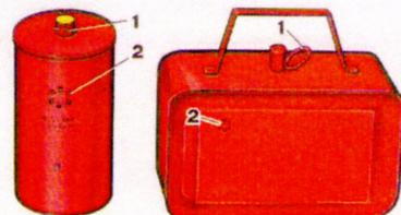
При срабатывании выделяется высокодисперсный аэрозоль, который тормозит пламенное горение.
