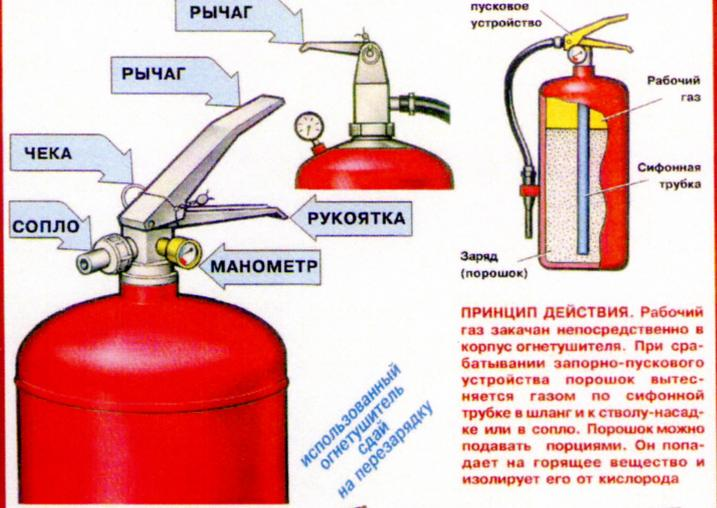
**ПРИНЦИП ДЕЙСТВИЯ.** Рабочий газ закачан непосредственно в корпус огнетушителя. При срабатывании запорно-пускового устройства порошок вытесняется газом по сифонной трубке в шланг и к стволу-насадке или в сопло. Порошок можно подавать порциями. Он падает на горящее вещество и изолирует его от кислорода
