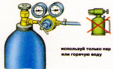
СВАРКА И РЕЗКА С ПРИМЕНЕНИЕМ СЖИЖЕННЫХ ГАЗОВ НЕДОПУСТИМЫ В ПОДВАЛЬНЫХ И ЦОКОЛЬНЫХ ПОМЕЩЕНИЯХ, КОЛОДЦАХ И ДРУГИХ ПОДЗЕМНЫХ СООРУЖЕНИЯХ
