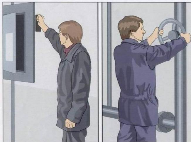
По команде руководителя аварийно остановить производство (оборудование). Отключить вентиляцию и электрооборудование. Перекрыть краны и задвижки на трубопроводах подачи газа, масла, агрессивных и горючих жидкостей. Открыть задвижки для их слива в аварийные ёмкости
